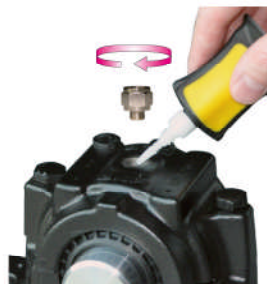
Reduziernippel einschrauben (Wenn nötig, Schmierstelle abdichten)
